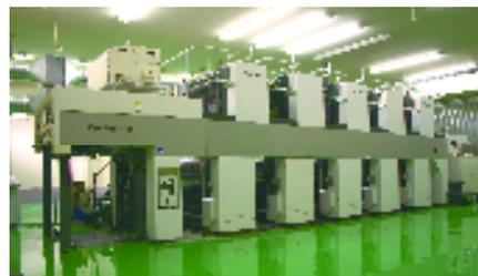
水なし印刷の機械(保木間工場)
