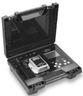
▶エレベーター用振動測定装置 ISO18738準拠 日本初の世界基準モデル
